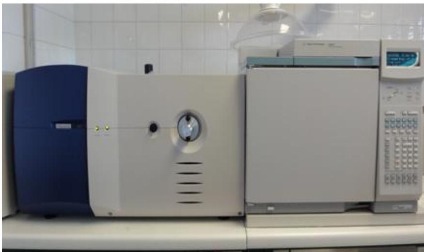
O GCT é um espectrómetro de massa com analisador por tempo de voo de aceleração ortogonal e de elevada resolução ( $\sim 7000$  FWHM), equipado com três fontes de ionização.
