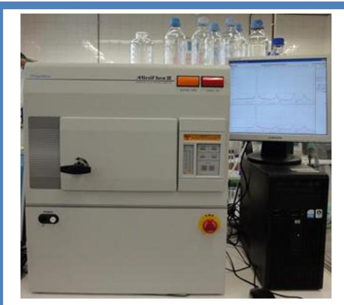
A difracção de raios-X de pós (XRD) é uma das técnicas utilizadas por mineralogistas e químicos do estado sólido para examinar o *make-up* fisico-químico de sólidos. Nesta técnica obtem-se um padrão de difracção através do registo da intensidade de raios-X em função do parâmetro de leitura (ângulo  $2\theta$ ).
