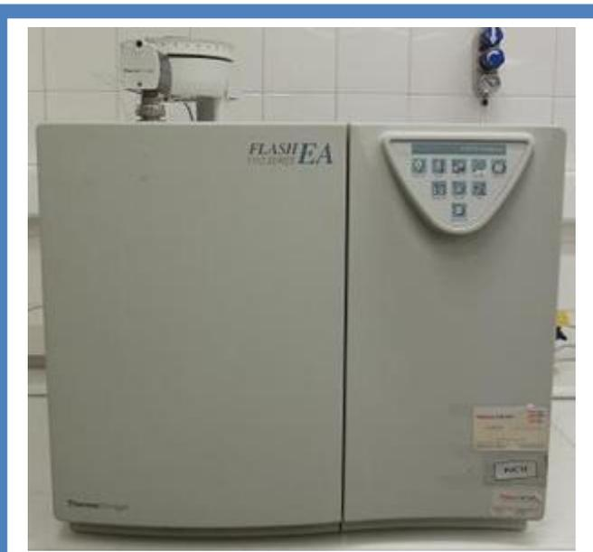
O analisador opera na base da combustão dinâmica da amostra. A amostra é pesada em cápsula de estanho e introduzida no reactor de combustão através de amostrador automático, conjuntamente com uma quantidade determinada de oxigénio.
