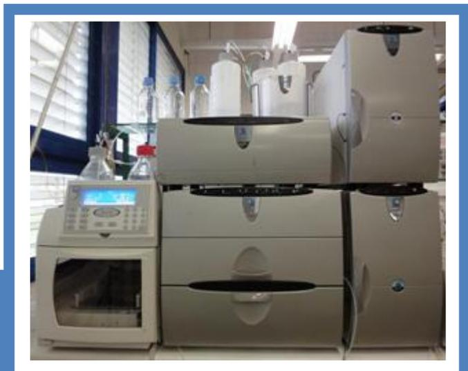
A cromatografia iónica revela-se uma técnica analítica versátil para a generalidade das espécies iónicas, tanto orgânicas como inorgânicas.
