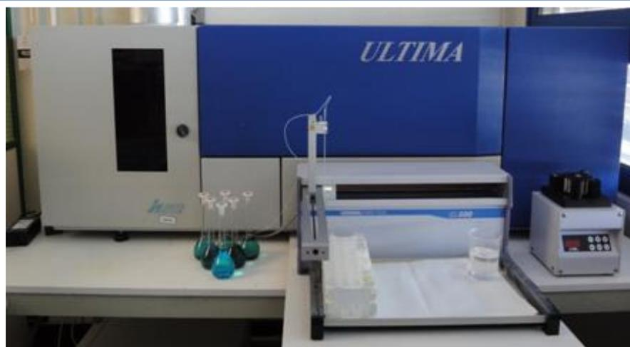
ICP-AES – Espectrometria de Emissão Atômica por Plasma Induzido é a técnica indicada para a análise de elementos em diferentes matrizes sólidas, líquidas, orgânicas e inorgânicas (materiais biológicos/ proteínas, células animais e vegetais, leite, peixe, águas, ligas metálicas, produtos de síntese/farmacêuticos ou outros), presentes em qualquer matriz que seja solúvel em meio aquoso (ácido, básico ou salino).
